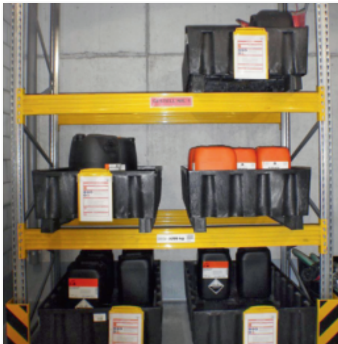
Abb. 2: Regal mit Anfahrtschutz und Auffangwannen für Chemikalien.
