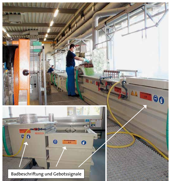
Alle Bäder sind klar und deutlich beschriftet. Die Gebotssignale sind direkt am Bad angebracht. Der Mitarbeiter sieht so auf den ersten Blick, welche Schutzausrüstung er tragen muss.
