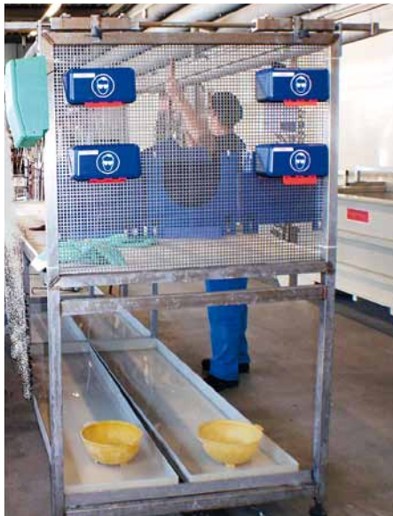
Jeder Mitarbeiter hat seine persönliche Schutzbrille. Seitlich im grünen Kasten befindet sich die schnell greifbare Augenspülflasche.
