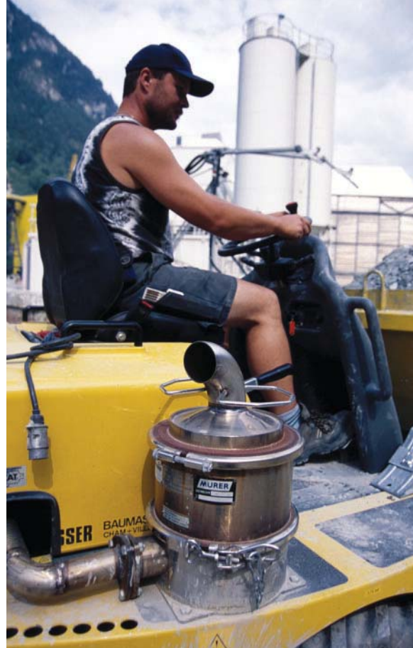
Effiziente Partikelfilter schützen den Maschinenführer und die Umgebung vor den krebserregenden Dieselabgasen (Bild: Fotoagentur Aura Luzern)
